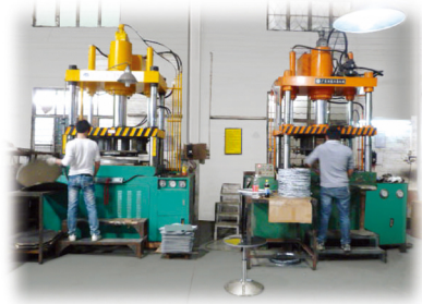
Hydraulische Pressen zum Tiefziehen Hydraulic presses for deep drawn products
