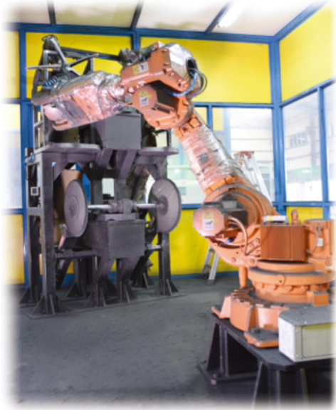
Vollautomatische robotergesteuerte Polieranlage für Fusskreuze / full automatic robot controlled polishing equipment for chair bases
